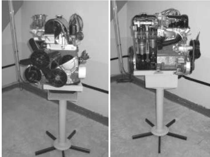
Рисунок 1 – Разрезная модель ДВС с навесным оборудованием
