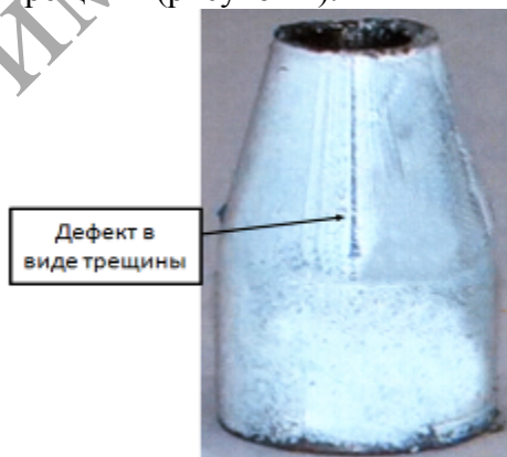
Рисунок 1 – Дефект в виде трещины
