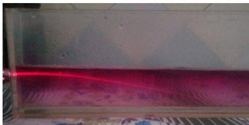
Рисунок – Распространение лазерного луча в слоисто-неоднородной среде
