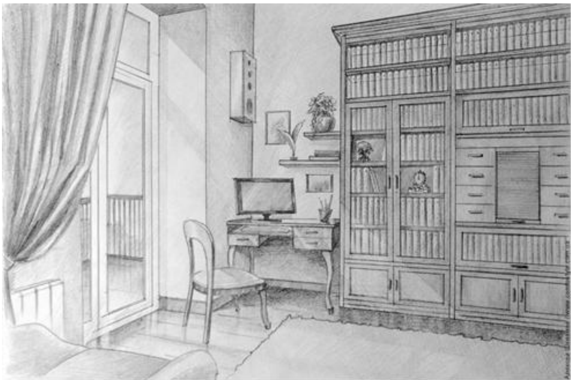
Рисунок 13.2. – Угловая перспектива рабочего кабинета, имеющая две точки схода
