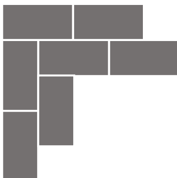
Рисунок 2. – Раскладка кирпича для кладки угла шириной в кирпич по однорядной системе перевязки швов
