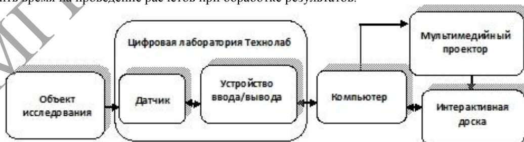
Рисунок 1 – Структурная схема установки для проведения активных демонстраций
