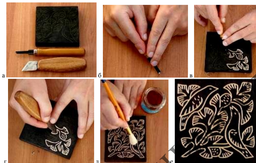
а – инструменты (нож-косяк, уголко́вая стамеска) и заготовка из древесины, б – правильное положение рук при резбе уголко́вой стамеской, исключающее срыв реза, в – резба уголко́вой стамеской, г – резба ножом-косяком, д – нанесение кистью лака на поверхность заготовки с вырезанным рисунком (закрепление резного рисунка), е – готовое изделие
