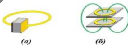
Рисунок 1. – (а) расщепленное кольцо со впаянной емкостью и (б) два элемента с магнитоиндуктивной связью
