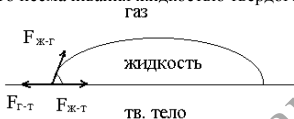
Рисунок 9. – Схема, поясняющая явление смачивания жидкости
