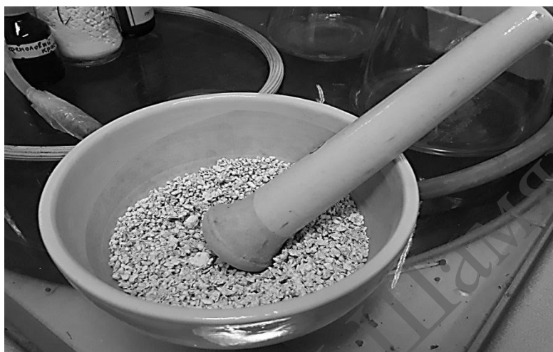
Рисунок 1. – Измельчение теплоизоляционных плит на основе вторичного полистирола
