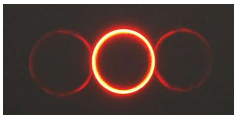
Рисунок 3. – Наблюдаемое на эксперименте расположение падающего и двух дифрагированных БСП в дальней зоне (кристалл TeO_2 , \lambda_0=633 нм, \varphi_1=\varphi_2=4,45^\circ , угловая расстройка \Delta\theta=0 , f=75 МГц, l=0,5 см, параметр конусности БСП \gamma=2,4^\circ )
