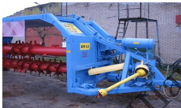
Рисунок 2.5 – Аэратор смеситель компостов (АСК-3,5)
