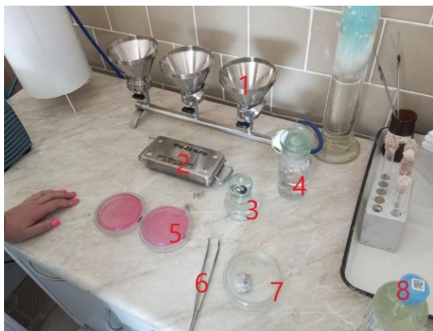
1 – прибор вакуумного фильтрования; 2 – стерильные мембранные фильтры; 3 – спиртовка; 4 – спирт; 5 – питательные среды; 6 – пинцет; 7 – вата; 8 – исследуемая вода
