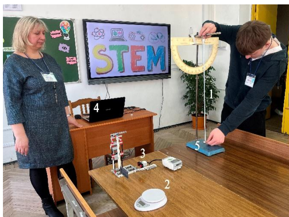
Рисунок 1 – Экспериментальный этап исследования: 1 – рулетка; 2 – весы; 3 – установка для наблюдения колебаний с помощью LEGO Mindstorms Education; 4 – ноутбук; 5 – экспериментальный макет математического маятника
