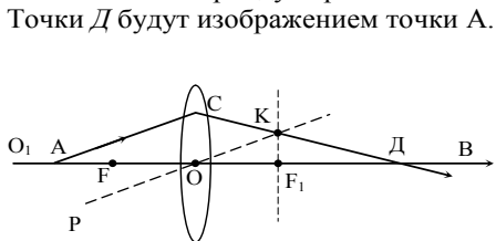
Рисунок 17.12. – Построение изображения точки, находящейся на оптической оси
