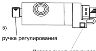
а) кнопки вращения деформационной головки; б) вывод результатов на дисплей Рисунок 4.10. – Включение тестера измерения твердости при вращении деформационной головки
